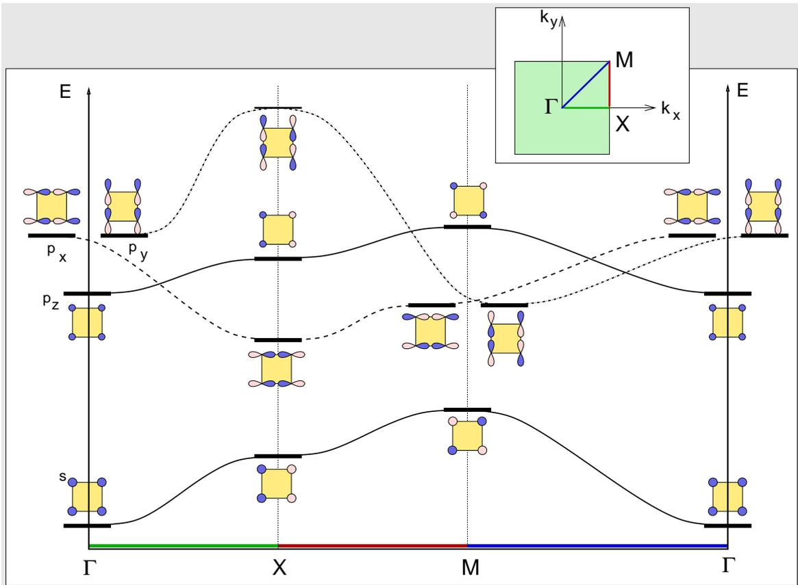
Bandstruktur eines quadratischen Netzes aus s- und p-Zuständen
