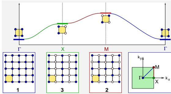
Bandstruktur eines quadratischen Netzes aus s-Zuständen
