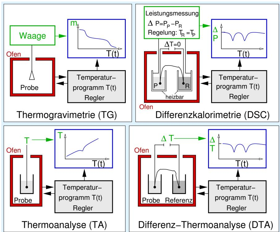
DTA zur Bestimmung von Phasendiagrammen
